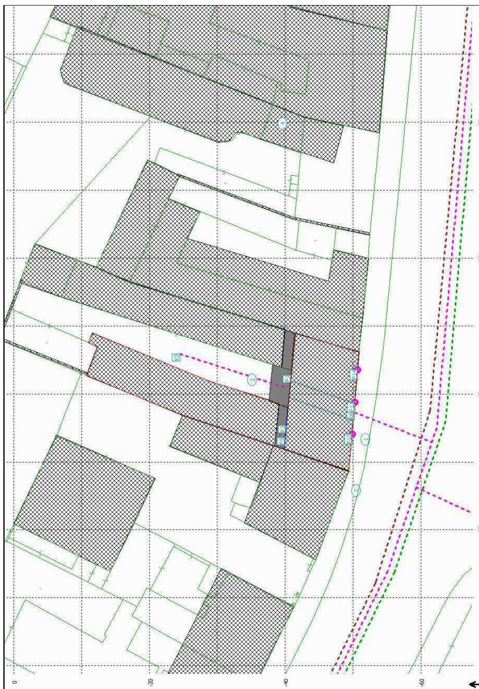
Obr. 4 Umístění imisních bodů výpočtu 1 až 4 – modelová situace
